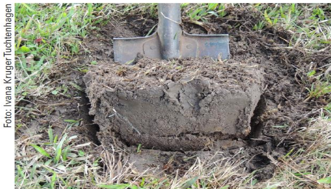
Figura 1 - Extração de um bloco de solo com pá de corte em área sob pastagem
